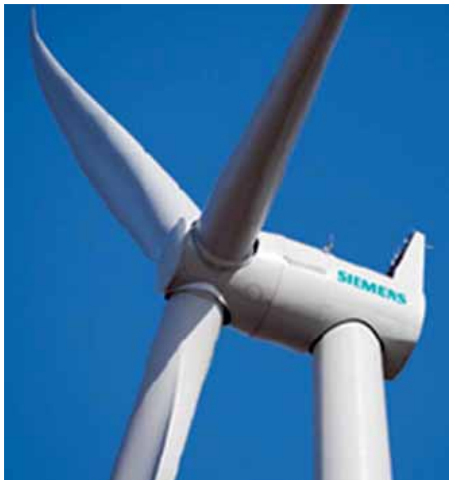
Foto 3.1 Gearløs vindmølle. Nacellen vejer ca. 73 ton.
