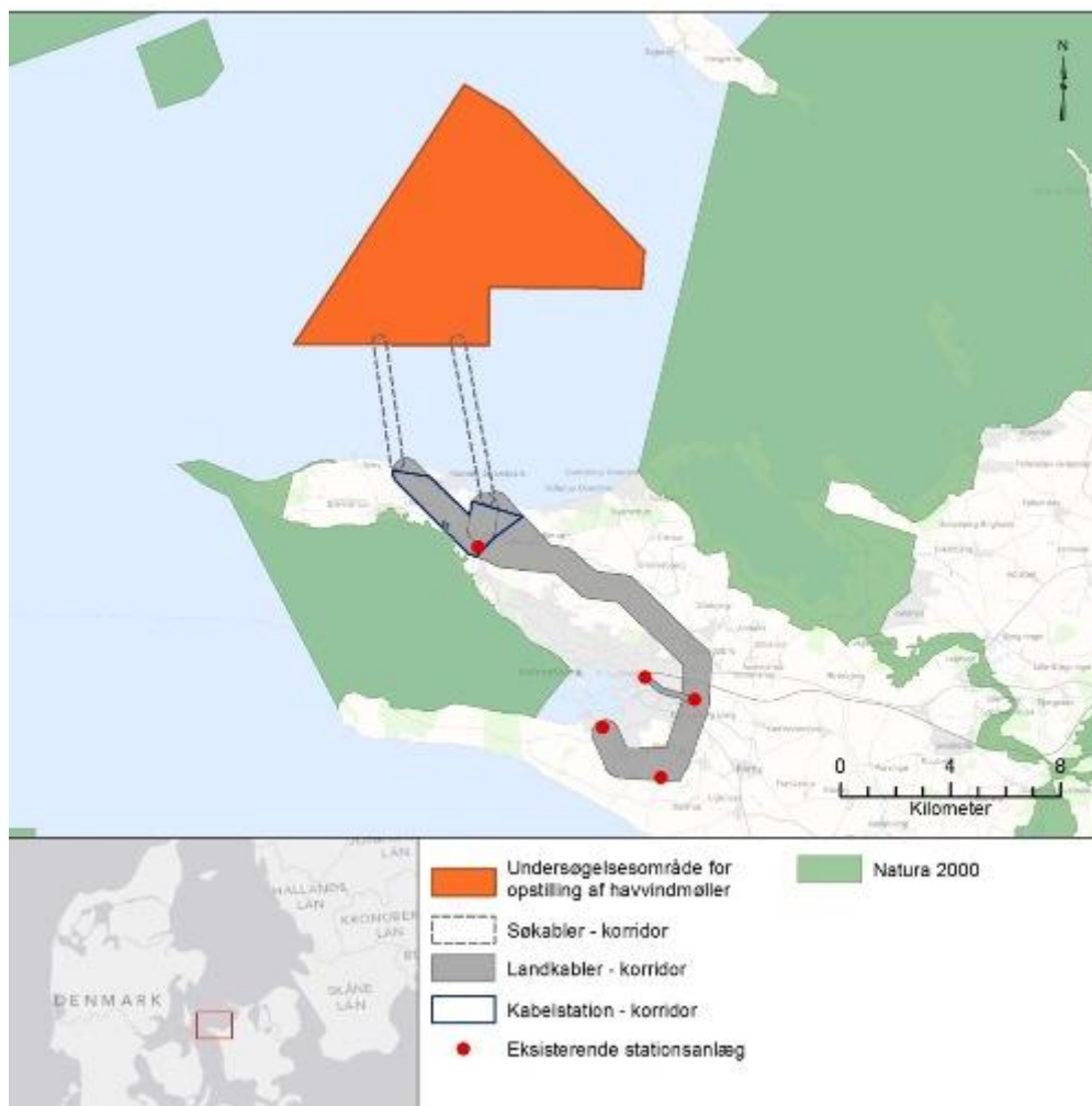
Figur 3 Tilkobling af havmøllepark ved Sejerø til Asnæsværket – øst om Kalundborg by.
