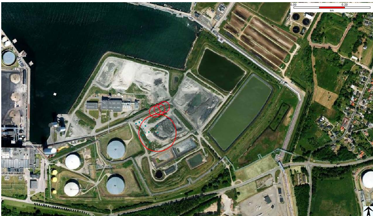
Figur 53: Røde cirkler repræsenterer et risikoniveau på 10^{-6} pr. år. Uden for disse cirkler er risikoen for dødsfald således under et acceptkriterie på 10^{-6} .
