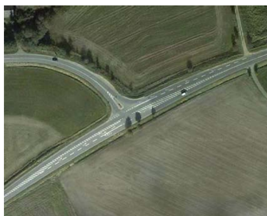
Figur 30: Eksempel på vejforløb med svingbane.
